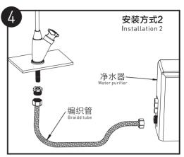
如外接编织管,请采用安装方式2,直接用六角螺塞连接净水螺管,然后将编织管与六角螺塞连接即可。最后打开龙头开关,检查各处连接位置是否有渗漏,若龙头正常出水无渗漏,则本产品安装完成。
