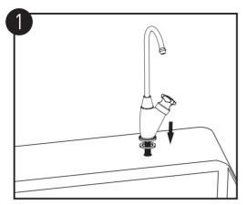
确保安装台面清洁、干燥的情况下,首先将台上橡胶垫圈安装 于龙头底部,再将龙头底座贴紧台面,并使净水螺管穿过台面 安装孔落于台面下方。
