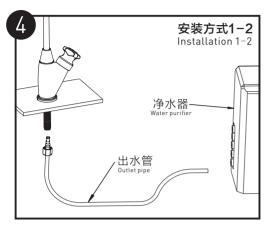
将装好的净水器塑料出水管塞入净水螺管,并拧紧安装螺母,最后打开龙头开关,检查各处连接位置是否有渗漏,若龙头正常出水无渗漏,则本产品安装完成。
