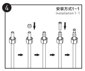
如外接净水器的塑料出水管,请采用安装方式1,如图所示,先将塑料出水管穿过安装螺母及塑料卡圈,再将塑料管装入塑料出水管。
