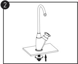
将台下橡胶垫圈、不锈钢垫片及齿形垫圈依次套入净水螺管。
