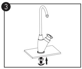
按顺时针方向拧紧安装螺母,需确保产品安装稳固。
