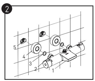
普通之字接头安装:将法兰罩(4)穿入弯头(5),使法兰罩与墙壁平齐。将垫圈(3)放入阀体上的连接螺母(2)内,并用扳手将连接螺母与弯头拧紧。
