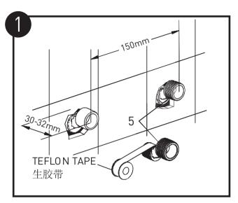
普通之字接头安装:用生胶带缠上弯头(5)较小的一头,然后接上供水管。要有足够的生胶带以密封弯头与出水管间的连接处。调整两弯头位置水平,相距150mm,并凸出墙面30-32mm。
