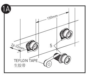
特殊之字接头安装: 用生胶带缠上弯头(5)较小的一头,然后接上供水管。要有足够的生胶带以密封弯头与出水管间的连接处。调整两弯头位置水平,相距150mm,并凸出墙面26-32mm。
