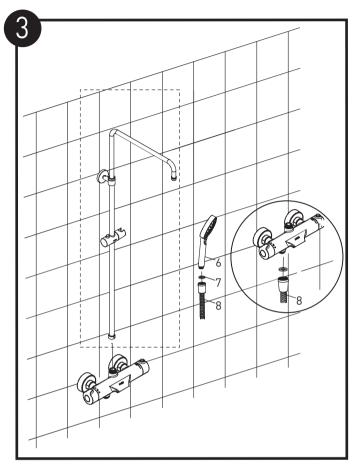
确保花洒软管(8)的两端都带有密封垫片(7)。将花洒软管的一端连接花洒(6),另一段连接阀体的花洒连接头。
