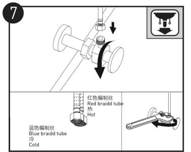
固定软管到角阀上,同时确保冷热水管连接满足冷热水控制 要求。
