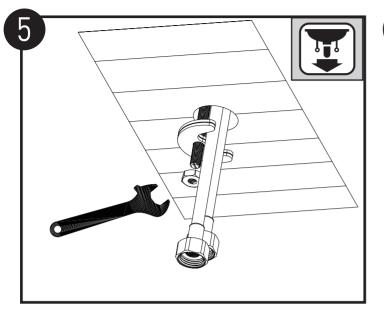
安装垫片和螺母,锁紧螺母至龙头本体完全固定。
