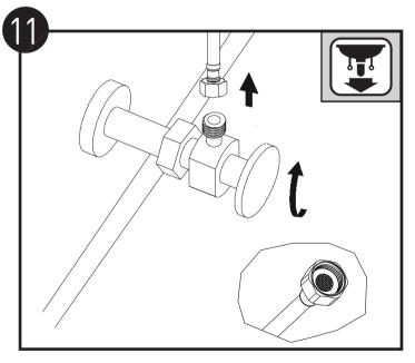
关闭角阀,旋下进水管,清洗进水管螺母中的滤网垫片; 清洗后重新旋紧进水管并打开角阀。
