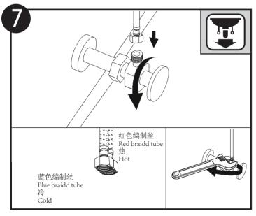
固定软管到角阀上,同时确保冷热水管连接满足冷热水控制要求。
