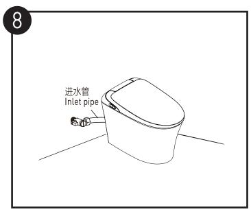
将坐便器进水管连接到角阀上。 Connect the toilet feed pipe to the filter.
