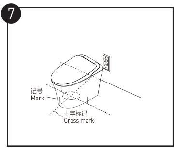
抬起坐便器,将陶瓷体上的记号对准地面十字标记,将坐便器慢慢 放到地面上调整使两者标记重合。将坐便器向下按压,使油泥充分 接触地面,与地面连接紧密。
