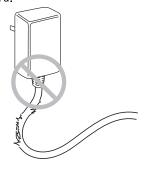
使用的电源插座请在规定的范围内 (交流220V±10%,最大电流10A以上)。
