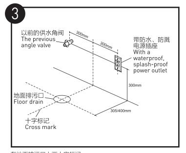
在地面排污口上画十字标记 将地面清洁干净,同时将水分擦干。 Make a cross mark on the floor drain Clean the floor and dry the water.
